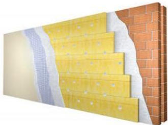
Coibentazione pareti perimetrali Costo intervento: € 157'000
